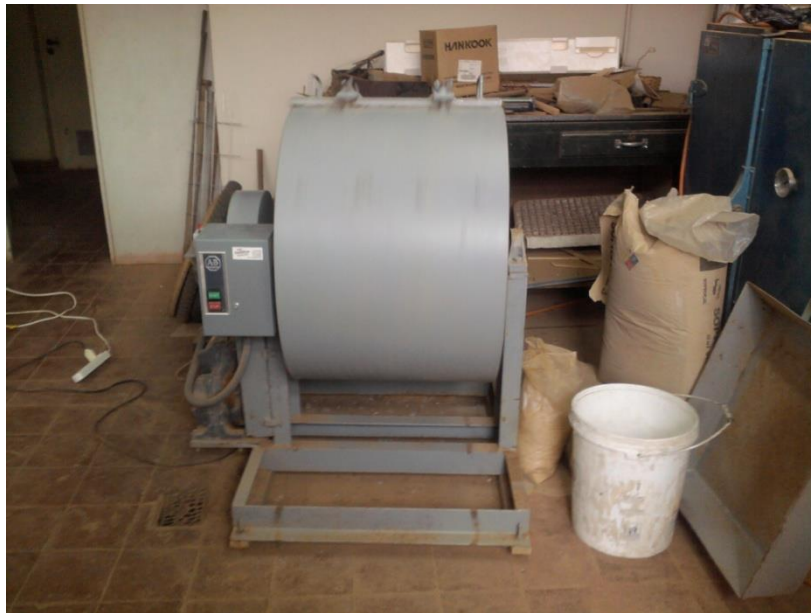
Figura 3.10: Instrumento para desgaste de áridos. (Desgaste de áridos de los Ángeles)
