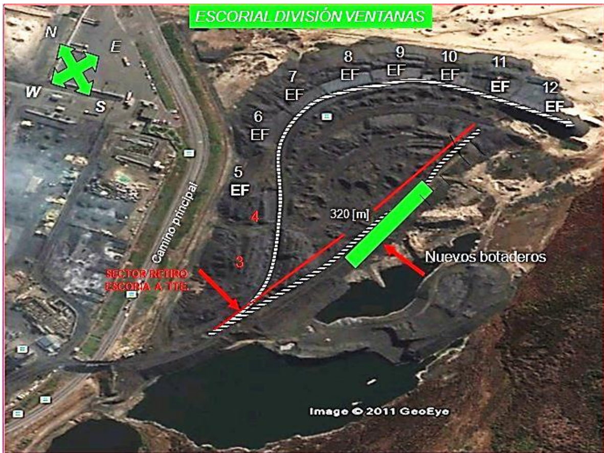
Figura 3.1: Sectores de acopio y retiro de materiales en el depósito. (Fuente: Elaboración propia).
