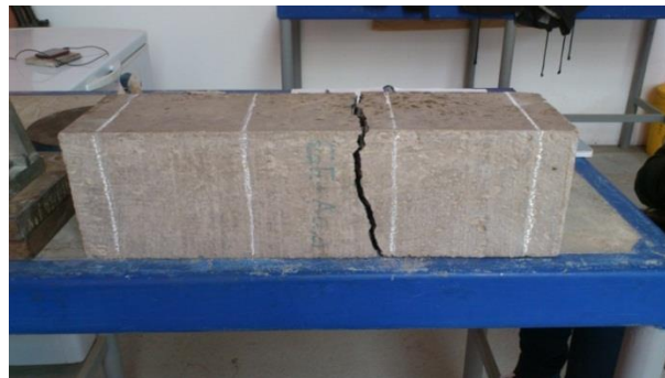
Figura 3.24: Viga luego del ensayo de tracción por flexión.
