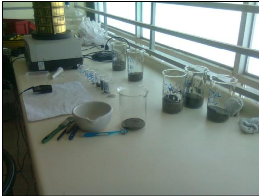
Figura 6-2: Balanza digital (arriba); Vasos precipitados (izquierda); Maquina Tamizadora (derecha). Fuente: Elaboración propia.
