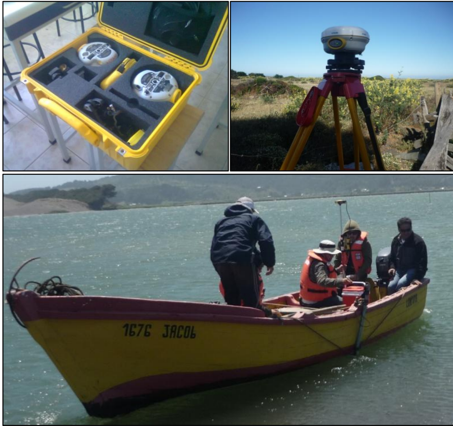
Figura 5-3: GPS Tramin (izquierda). GPS doble frecuencia (derecha). Proceso de batimetría con GPS móvil (abajo).
