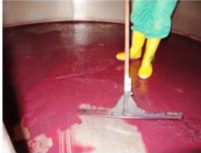
Figura 5.19: Limpieza en seco de cubas con barre agua.
