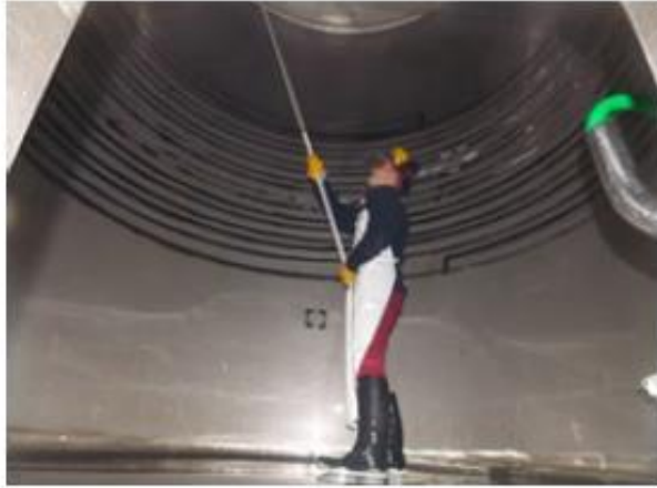
Figura 5.18: Limpieza en seco de cubas con cepillo extensible.
