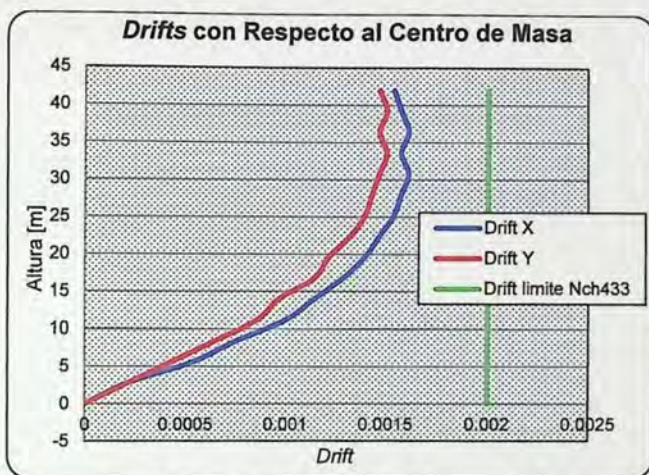
Figura 2.2: Drift de entre piso en direcciones X e Y.
