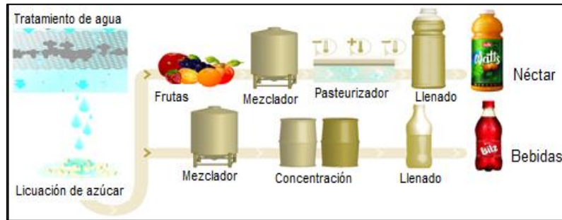
Figura1- 5: Proceso productivo de bebidas gaseosas y néctar. Fuente: (CCU S.A., 2014).
