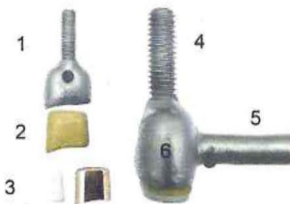
Figura 27: Se muestran las partes de los modelos de estudio. A la izquierda, se encuentran: 1, el marco de metal fundido, 2, la cofia electroformada, y 3, coronas primarias cónicas de zirconio y la otra de aleación de oro. A la derecha, están las tres partes que se combinaron para un espécimen. 4: muestra el tornillo necesario para la fijación. 5: muestra el brazo de carga axial. 6: muestra la carcasa del marco metálico que lleva la cofia electroformada.
