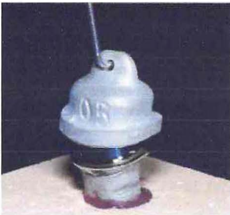
Figura 28: Modelo experimental donde se observa la corona secundaria puesta sobre la corona primaria de 0^\circ con su chaflán cervical.
