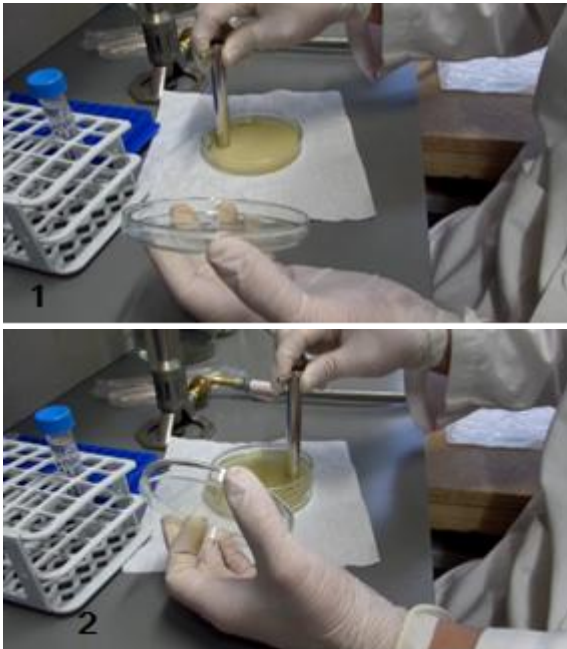
Imagen 5: Ejecución de los boquetes con sacabocado.
