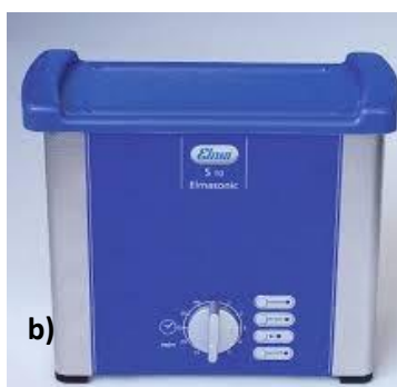
Imagen 3: a) Disolución de extracto en Vortex b) Baños con ultrasonido Elmasonic
