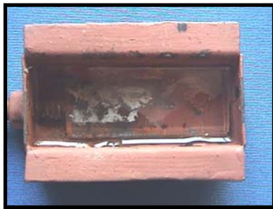
Figura 12-13. Figura 12, cuerpo de prueba en recipiente especial sumergido en saliva artificial. Figura 13, diente natural montado en vástago de acero ejerciendo carga contra cuerpo de prueba.
