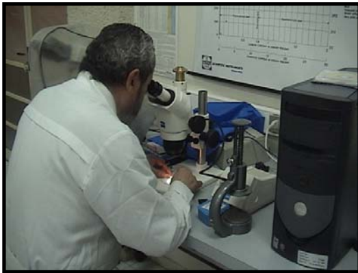
Figura 16-17. Figura 16, observación de los desgastes mediante lupa estereoscópica Zeiss. Figura 17, pulsador Veto con resolución de 0,001 mm.
