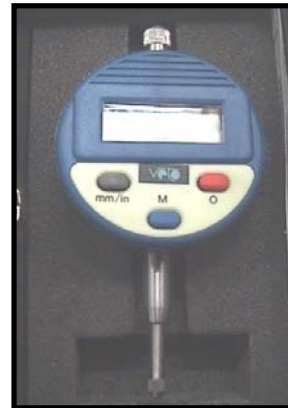
Figura 16-17. Figura 16, observación de los desgastes mediante lupa estereoscópica Zeiss. Figura 17, pulsador Veto con resolución de 0,001 mm.
