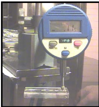
Figura 18-19. Figura 18 se aprecia el pulsador durante proceso de medición. Figura 19, punta de medición del pulsador recorriendo faceta de desgaste.
