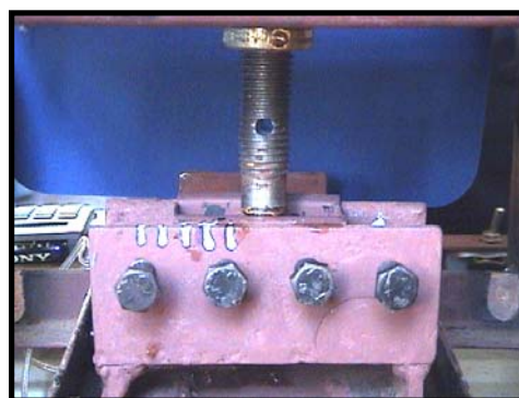
Figura 14-15. Figura 14, vista lateral máquina de ensayo, señalado con flecha roja la bandeja sobre la cual se posicionan los lingotes de plomo para lograr ejercer la carga deseada sobre el cuerpo de prueba. Figura 15, Vista frontal recipiente de cuerpo de prueba y vástago que porta el diente que aplica la carga.
