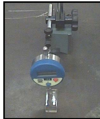
Figura 20-21. Figura 20, esquema del pulsador montado en soporte magnético. Figura 21, se aprecia el pulsador montado en el soporte magnético durante el proceso de medición de los desgastes.
