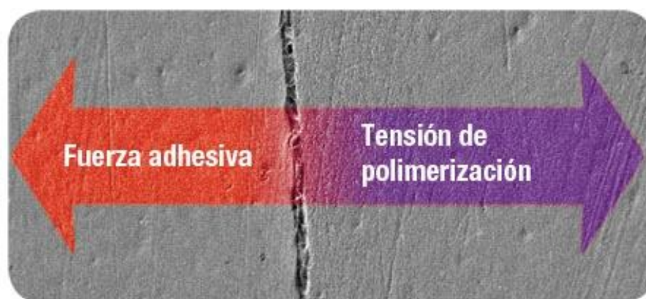
Figura 12: Formación de brechas debido a la tensión de polimerización.
