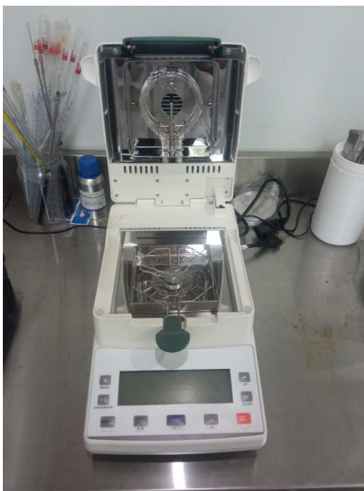
Figura 5.1: Balanza de humedad utilizada PCE INSTRUMENTS, Serie PCE-MA.
