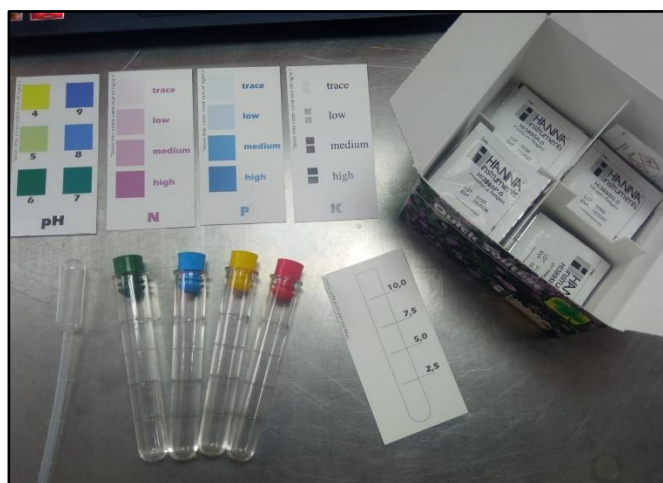
Figura 5.6: Kit utilizado para medición de NPK y pH.
