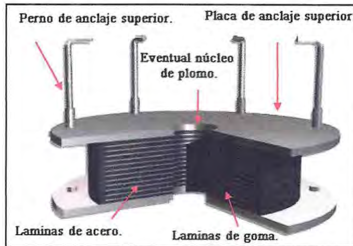
Figura 2.3- Componentes del aislador elastomérico. Fuente: Carl Lüders (2013).
