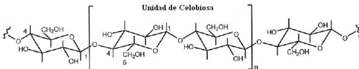
Figura 1.- Estructura primaria de la celulosa (Barroso, 2010).
