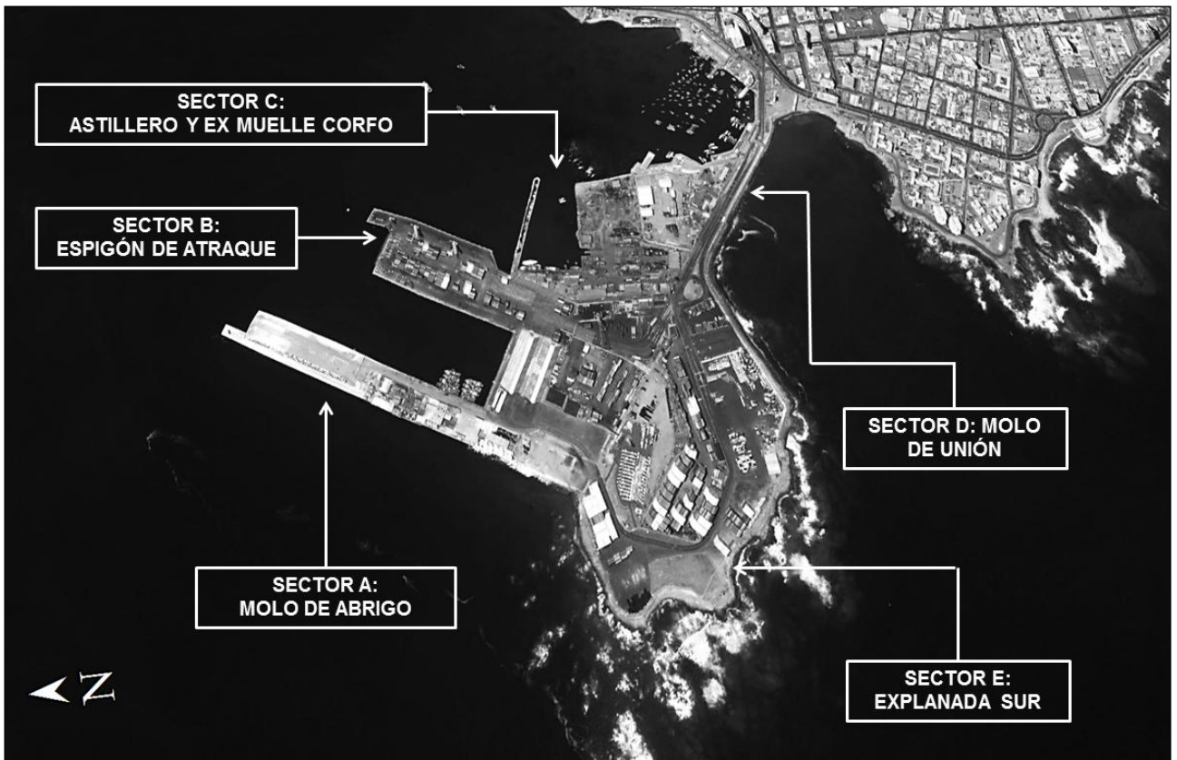
Figura 3.3: Sectores de la actual configuración del Puerto de Iquique. (Fuente: Elaboración propia a partir de Google Earth).
