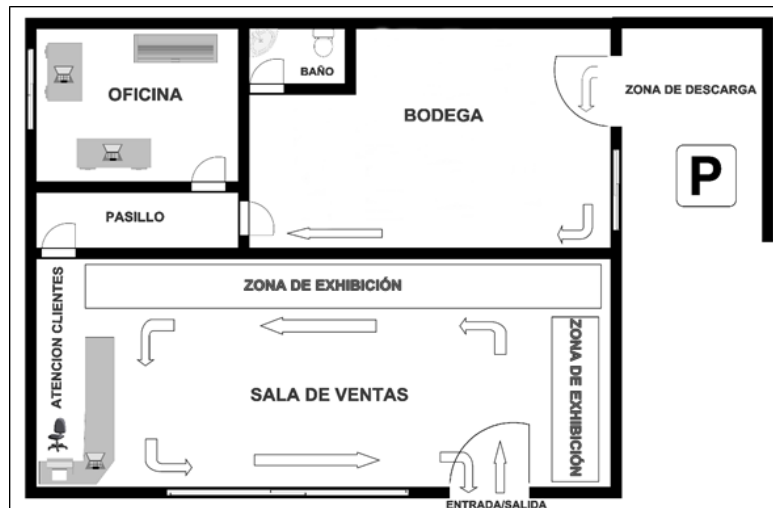
Figura 7: Layout de instalaciones del local
