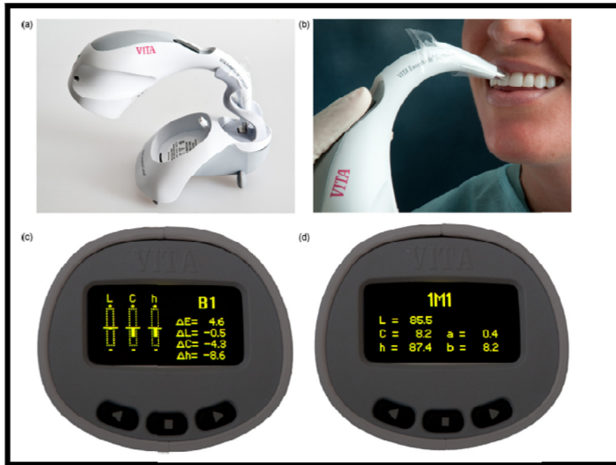
Figura N° 20: Vita Easyshade Compact. a). Calibración del instrumento, b). Medición del color, c). Valores de las mediciones de color comparadas con su correspondiente en Vitapan Clasico, d). Correspondencia de los valores con Vitapan 3D- Master.
