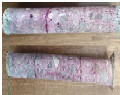
Figura 5.7 Medición de penetración de carbonatación
