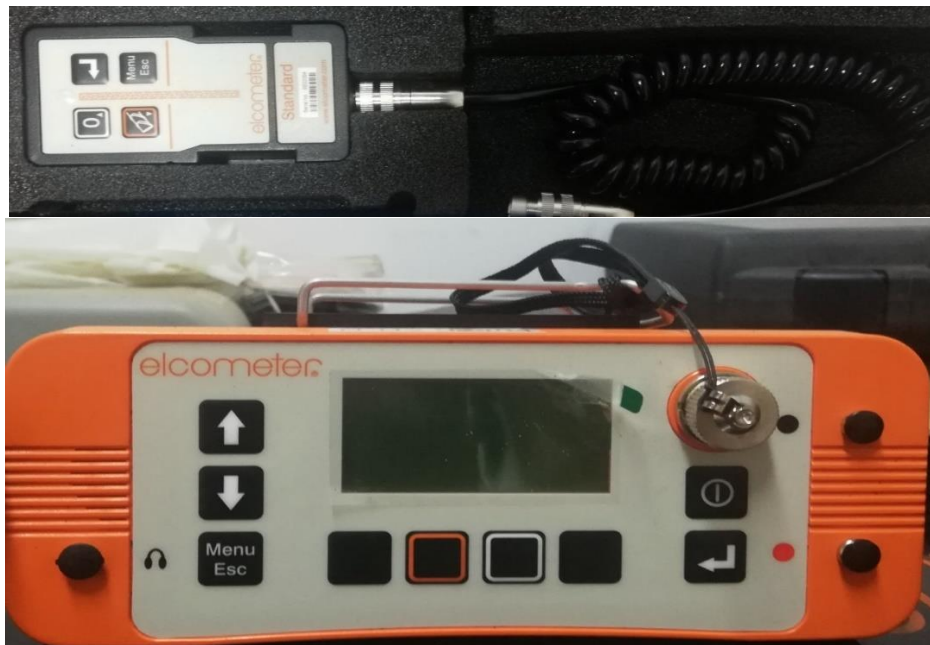
Figura 3.1 Medidor de hormigón Elcometer 331 Model BH Fuente: Elaboración propia
