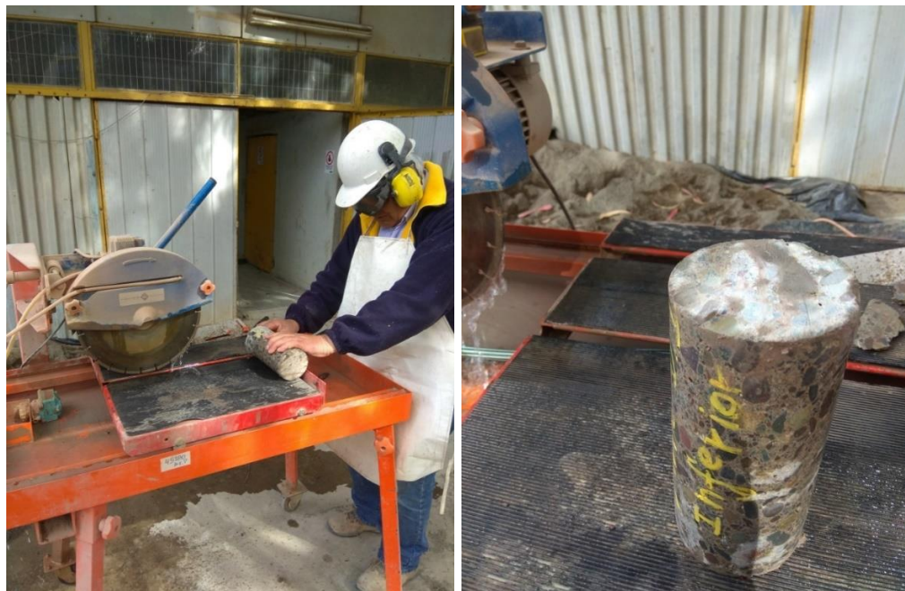
Figura 4.14 Corte de testigos Fuente: Elaboración propia
