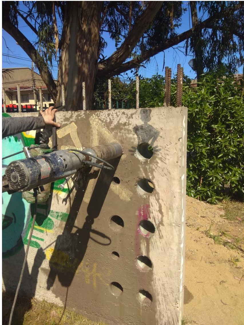
Figura 4.13 Extracción de testigos Fuente: Elaboración propia
