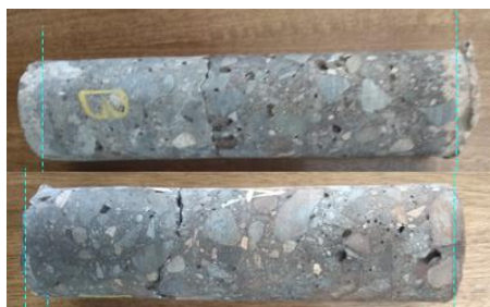
Figura 5.8 Medición de penetración de ion cloruro
