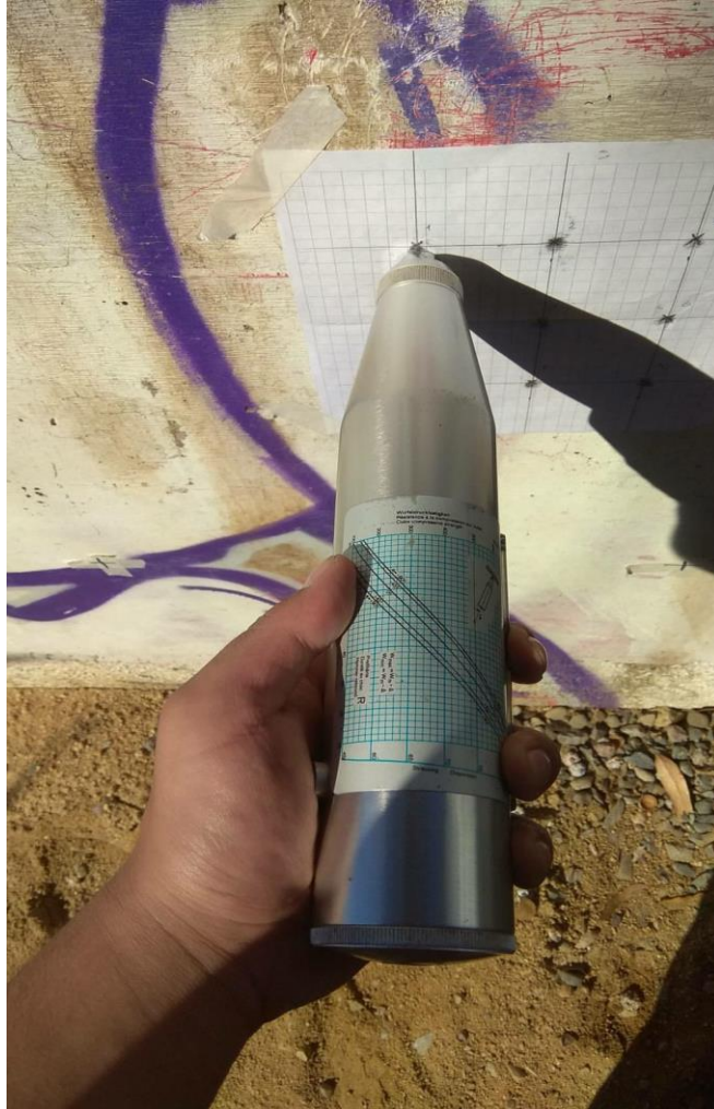
Figura 4.10 Uso del martillo Schmidt Fuente: Elaboración propia
