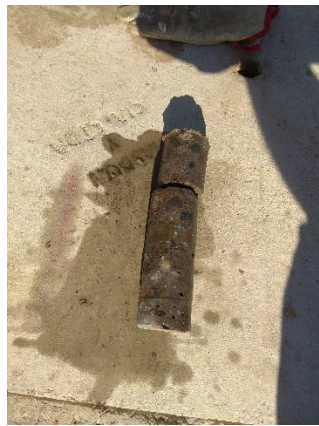
Figura 4.20 Aplicación de nitrato de plata sobre testigo Fuente: Elaboración propia
