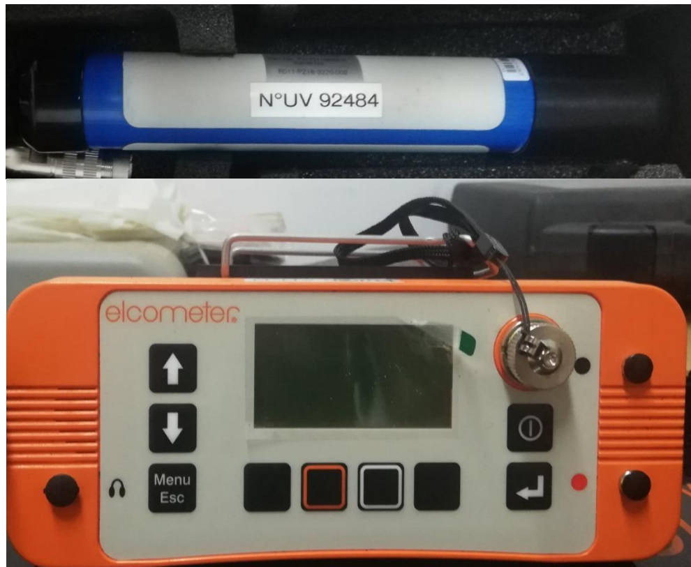
Figura 3.2 Medidor de media celda Elcometer 331 Model BH Fuente: Elaboración propia
