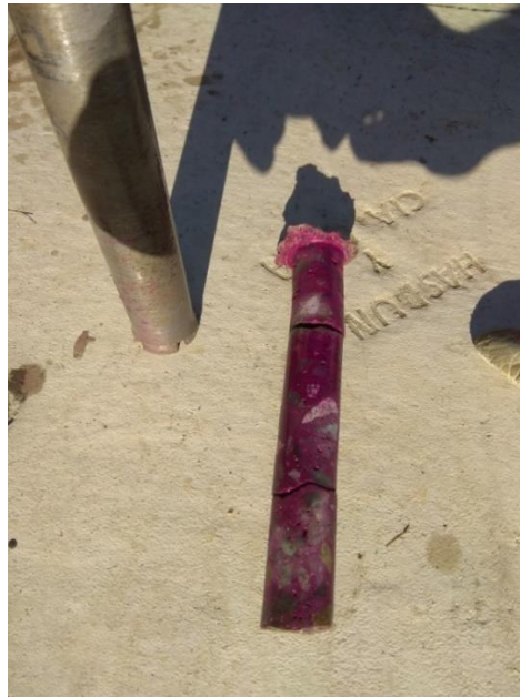
Figura 4.17 Aplicación de fenolftaleína sobre testigo Fuente: Elaboración propia
