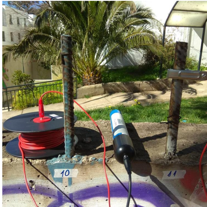
Figura 4.6 Medición de potencial de corrosión Fuente: Elaboración propia
