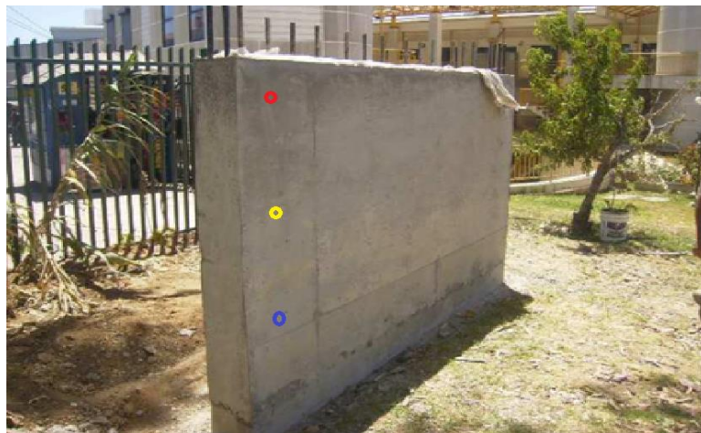
Figura 4.3 Estación de monitoreo A Facultad de Arquitectura, Playa Ancha Valparaíso Fuente: (Bustos, 2011) Understanding Performance of Concrete using natural pozzolans against Corrosion
