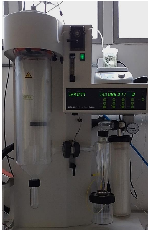
Figura 4. Mini Spray Dryer B-290 (Buchi) disponible en el laboratorio utilizado para producir microesferas DOX-GA.
