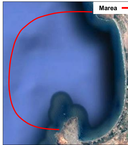
Figura 5-3: Condición de borde impuesta en la frontera abierta del modelo hidrodinámico. Fuente: Elaboración propia.
