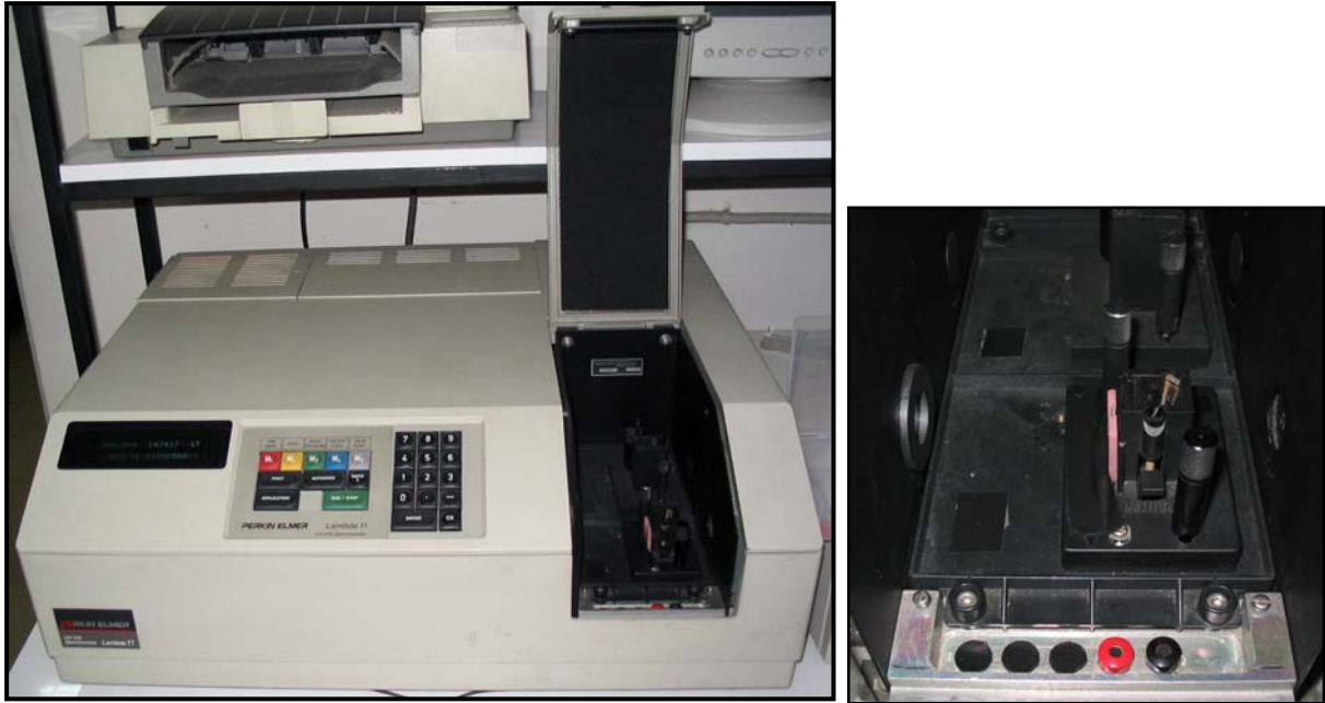
Figura 43. Espectrofotómetro Perkin Elmer, modelo Lambda 11. Compartimento de ubicación de muestras con su tapa abierta.
