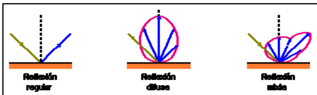
Figura 5. Esquemas de los diferentes tipos de reflexión.
