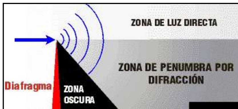
Figura 13. Difracción, desviación de los rayos luminosos cuando inciden sobre el borde de un objeto opaco.
