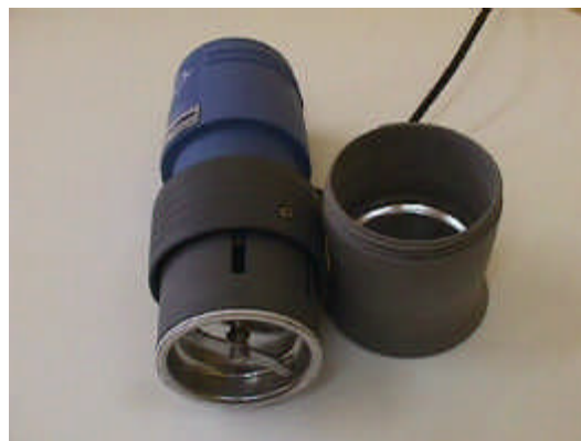
Fig. 19. Molino Arquimed, para triturar muestra.
