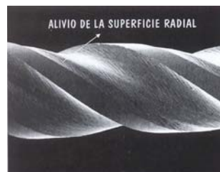
Figura n°5: Alivio de la superficie radial en una lima NiTi
