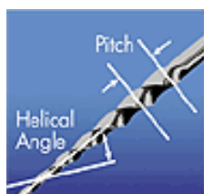
Figura n° 17 Variación del ángulo helicoidal ProTaper Universal®
