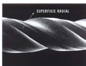
Figura nº2: Superficie radial de una lima NiTi.
