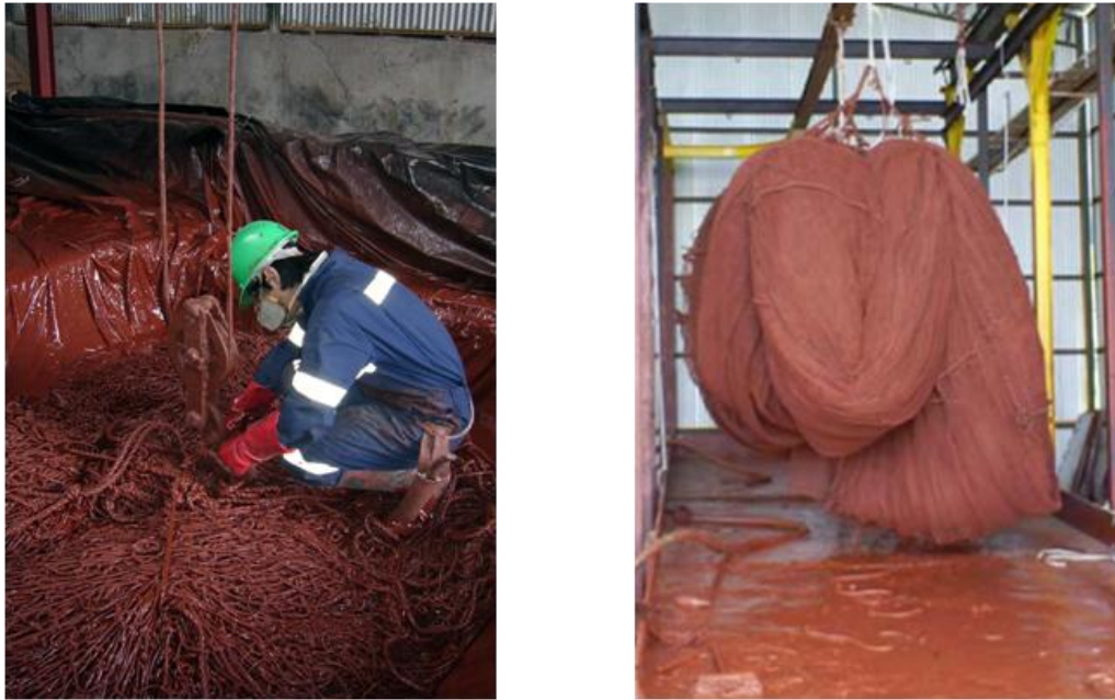
Figura N° 7: Impregnación de Redes Fuente: Propia
