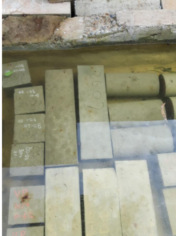
Figura 5.4: Cámara de Curado
