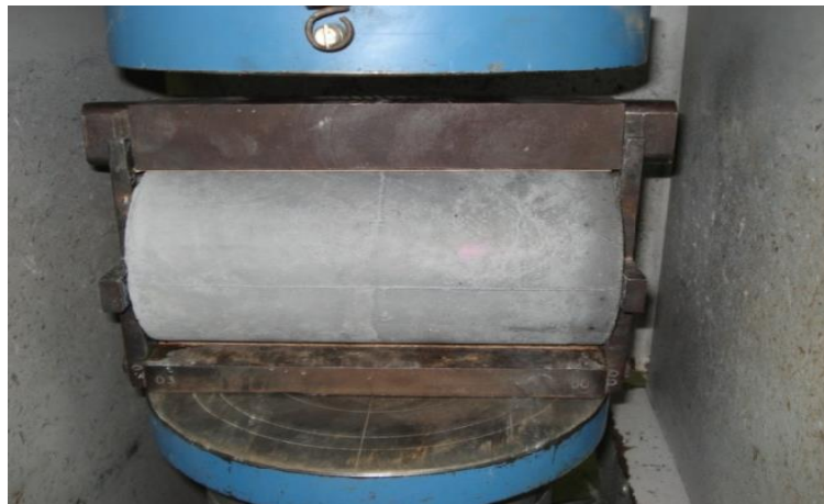
Figura 3.3: Ensayo de hendimiento Fuente: Elaboración propia
