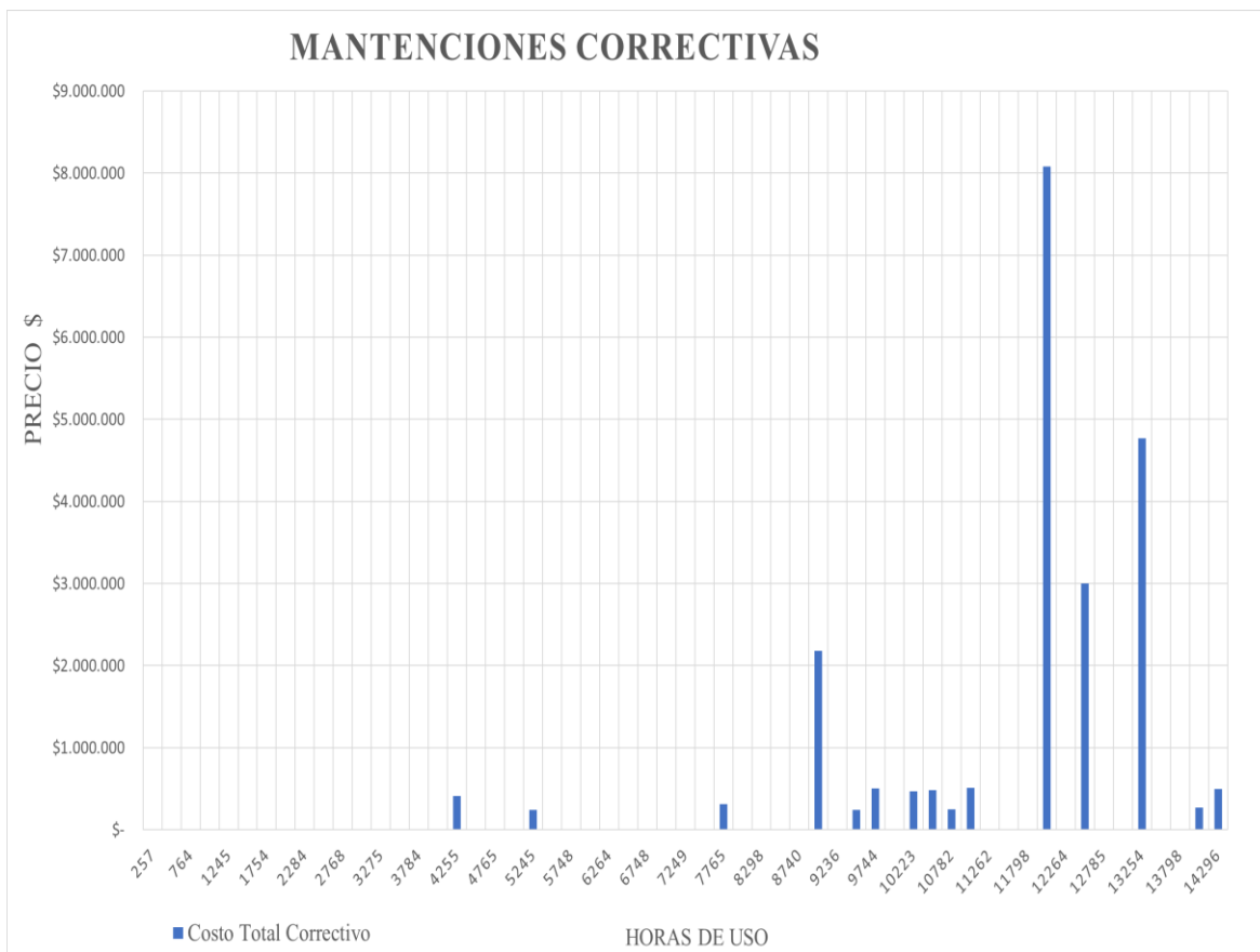
Figura 18: Grafico de mantenciones correctivas de la motoniveladora.
