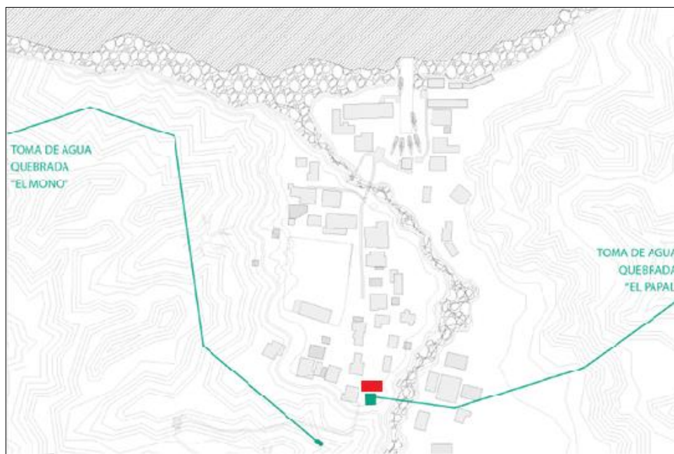
Figura N° 20. Zonas de toma de agua o captación y estanques de Isla Alejandro Selkirk, con el posible lugar de implementación de la planta desalinizadora de agua de mar y nuevos sistemas de almacenamiento de agua para consumo humano, destacado en rojo. (Ibarra, 2019. Editado).
