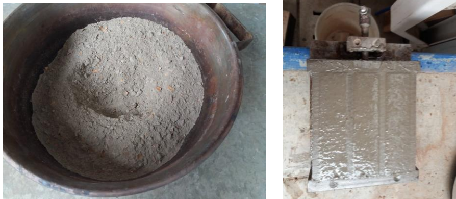
Figura 0.10: Mortero de prueba con 50% de cáscara de almendras.
