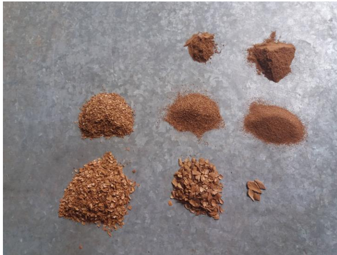
Figura 0.7: Granulometría de la cáscara de almendras molida. Fuente: Elaboración propia. 2017.
