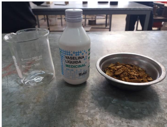
Figura 0.9: Materiales para realizar densidad real de la cáscara de almendras.
