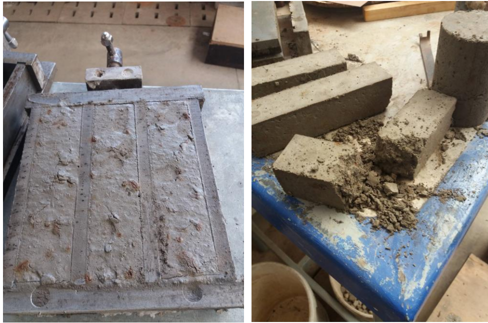
Figura 0.11: Mortero de prueba desmoldada.
