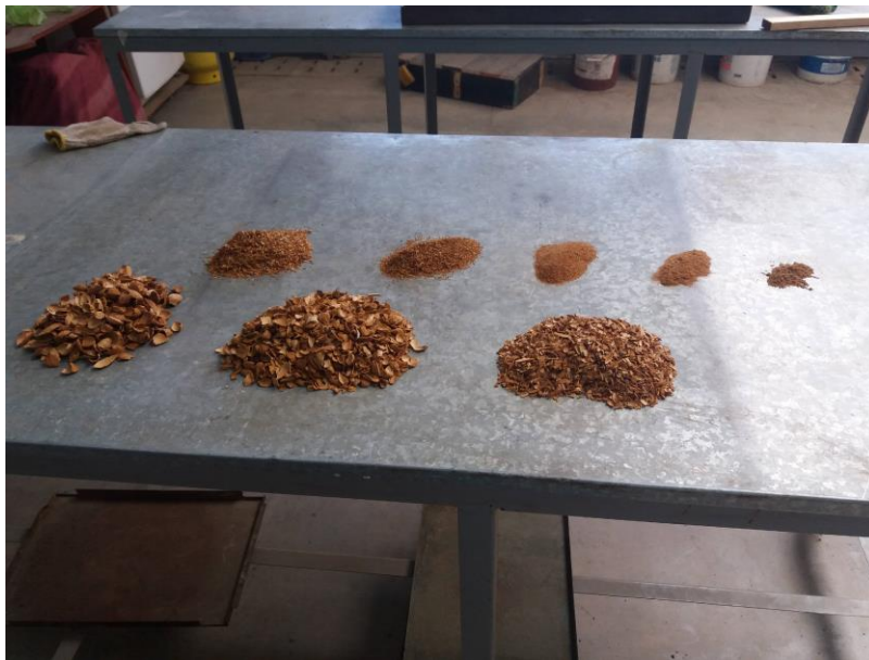
Figura 0.4: Granulometría de la cáscara de almendras.
