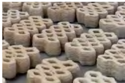
Figura 7: Ladrillo de cascara de huevo impreso en 3D. Fuente: Green Product Award.
