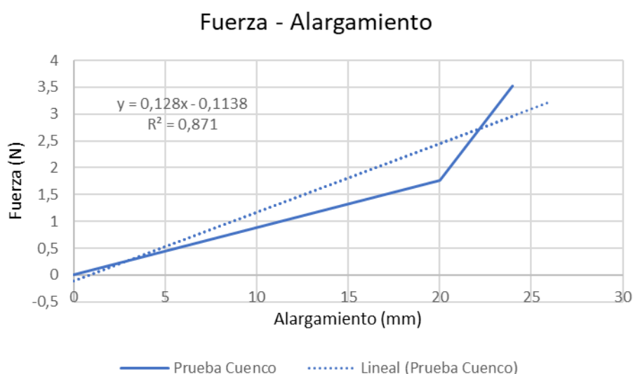
Figura 6.26: Gráfica Fuerza-Alargamiento del ensayo de flexión del biomaterial en forma de cuenco.
