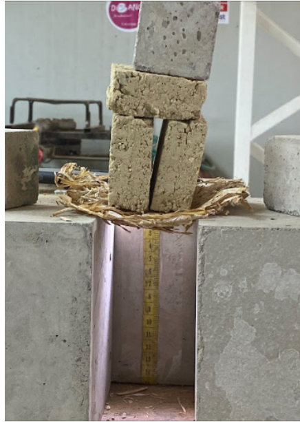
Figura 5.25: Ensayo de flexión en tres puntos del biomaterial fabricado.
