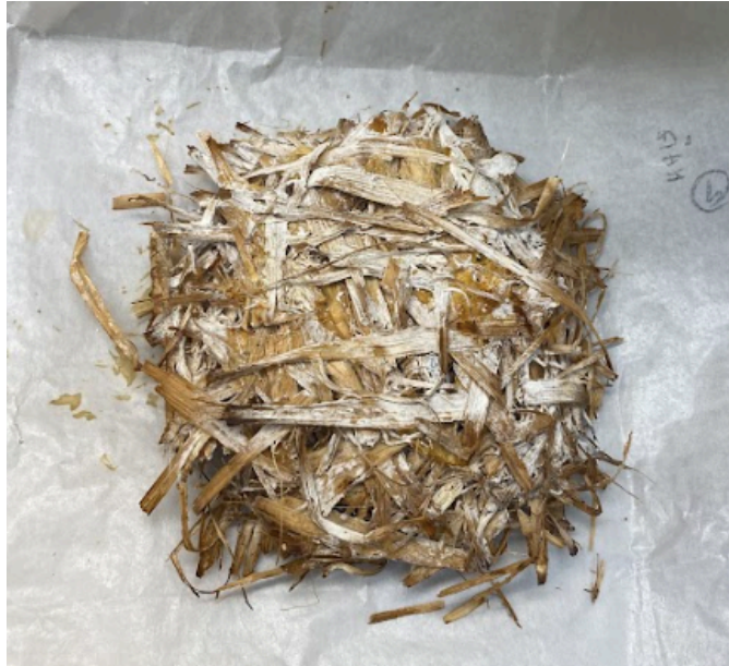
Figura 5.12: Prueba 3 antes de ser introducida al horno.
