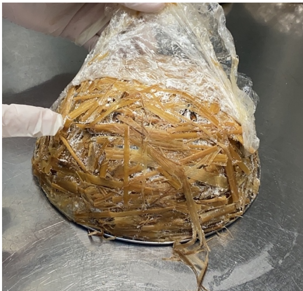
Figura 5.22: Desmolde previo del material
