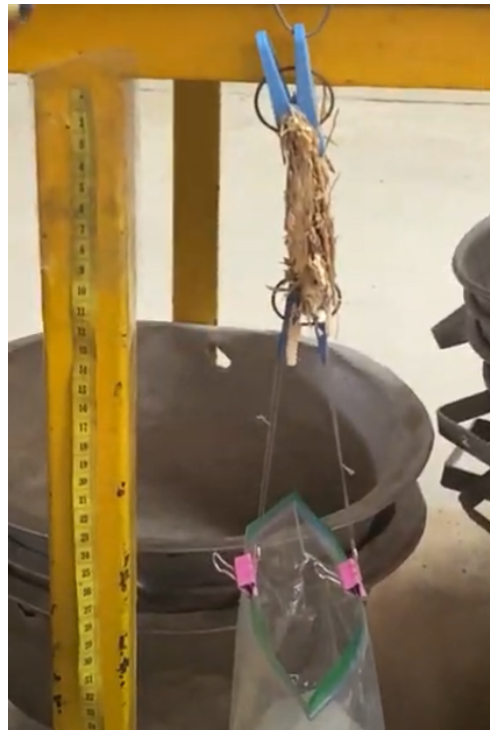
Figura 5.24: Ensayo de tracción del biomaterial fabricado.
