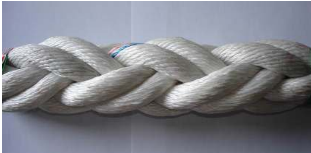
Figura 8-4: Polipropileno 8 – Strand [Fuente: Referencia 1].
