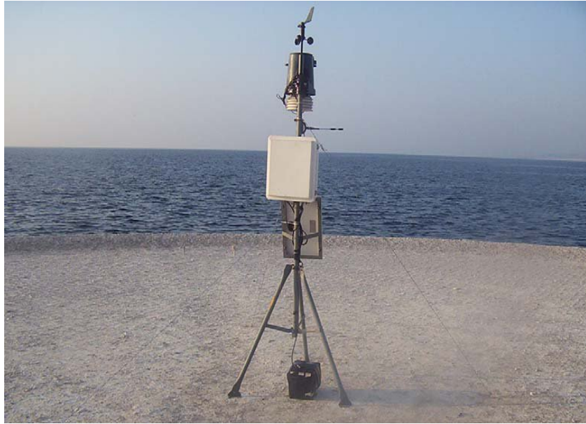
Figura 5-3: Estación Meteorológica Vantage Pro 2 [Fuente: Referencia 9].
