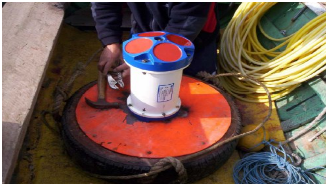
Figura 5-7: ADCP Marca RD Instruments, Modelo WorkHorse Sentinel [Fuente: Referencia 10].
