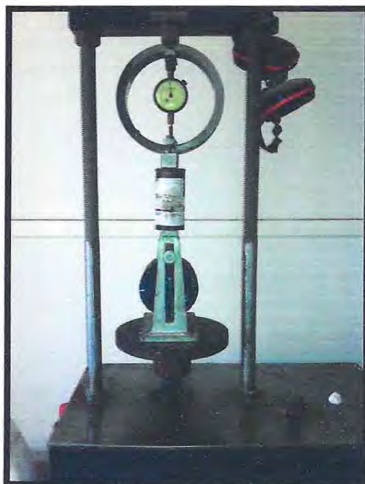
Figura 4.2: Ensayo Tracción Indirecta
