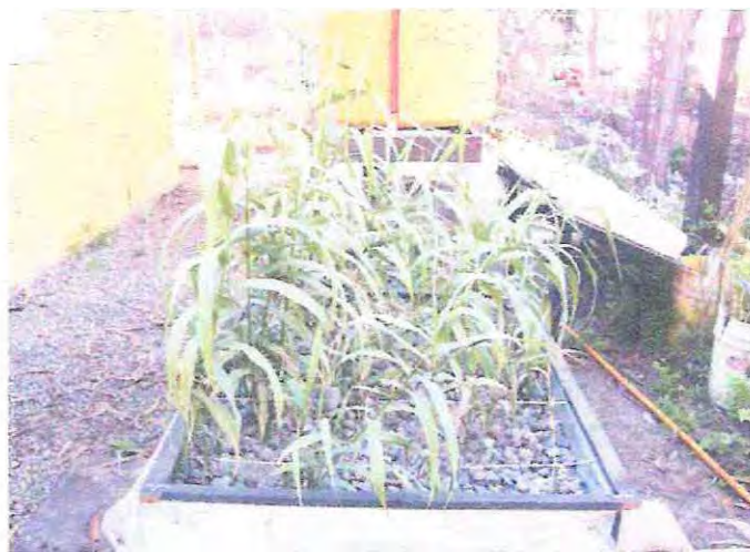
Figura N° 4.7 Fotografía humedal experimental grava - caña común ( arundo donax ) Universidad de Valparaíso
