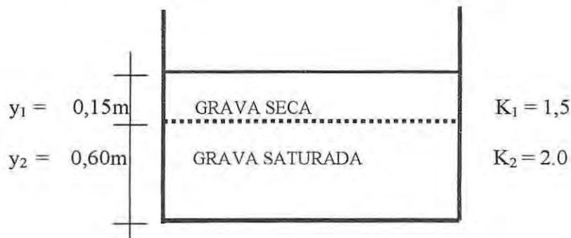
Figura N° 4.1 Esquema estructura medio filtrante para humedal de diseño
