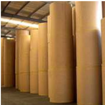
Figura 1.4, test liner, fuente http://www.cpp.cl
