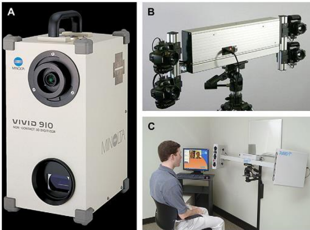
FIG 25. La Konica-Minolta Vivid 9i (Konica-Minolta Sensing America, Inc.; Ramsey, NJ) es un escáner láser (A) y Dolphin DI3D (Dolphin Imaging, Chatsworth, CA) (B) y 3dMD (Atlanta, GA) (C) son sistemas de estereofotogrametría. (Cortesía de MedCAD, Dolphin Imaging y 3dMD).
