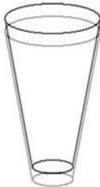
Figura. Imagen esquemática del sistema cono morse (morse taper)
