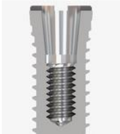
Figura. Imagen esquemática de la conexión con morse, en el cual se ve el cono “hembra” del implante.
