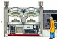
Figura 43: Etapa de Vulcanización de Neumático en Verde.
