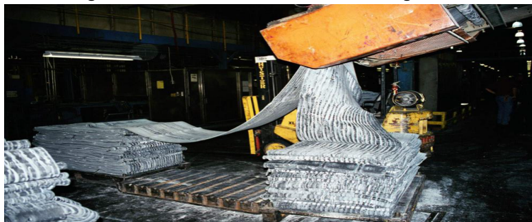
Figura 37: Plataformas con láminas de goma.
