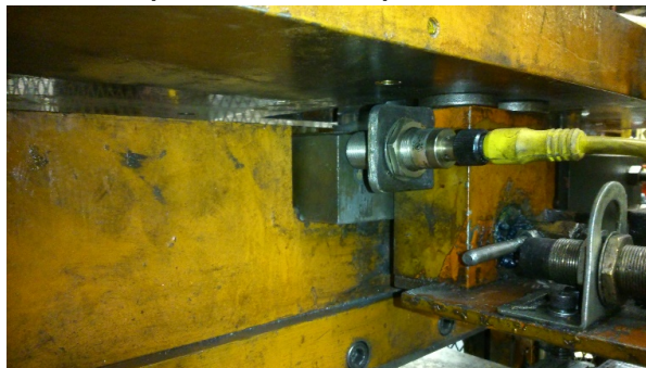
Figura 28: Cuchillo arriba en posición correcta, por tanto, sensor envía señal de OK.
