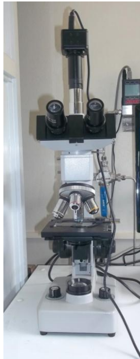
Figura 3.9. Microscopio óptico para evaluación preliminar de grafeno, \text{TiO}_2 y nanoestructuras híbridas.
