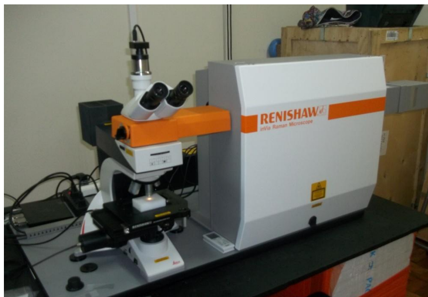
Figura 3.6. Espectrómetro Raman para la caracterización de grafeno y dióxido de titanio.
