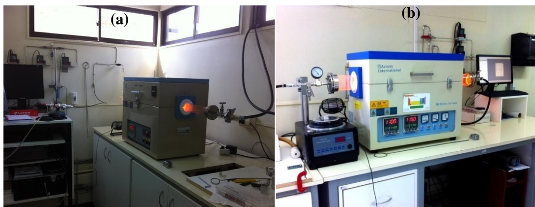
Figura 3.1. Sistema CVD para síntesis de grafeno e híbridos grafeno- \text{TiO}_2
