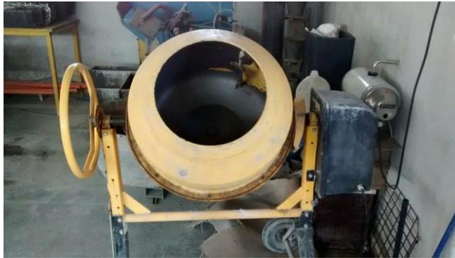
FIGURA 16: Betonera eléctrica.
