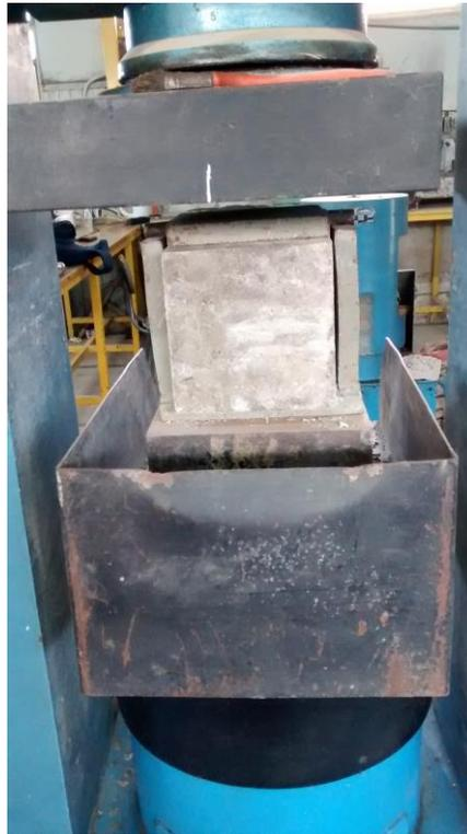
FIGURA 22: Ensayo a compresión mediante el cubo modificado.
