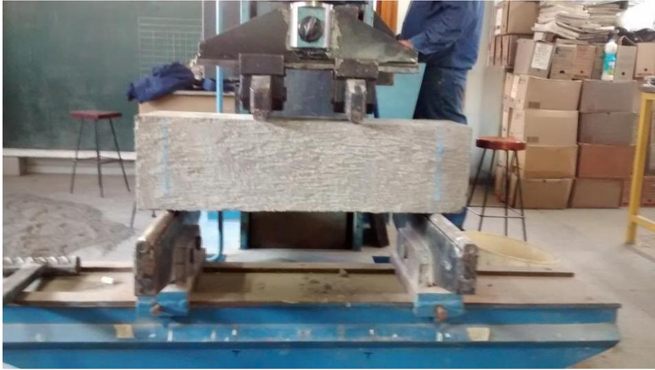
FIGURA 20: Ensayo a flexotracción
