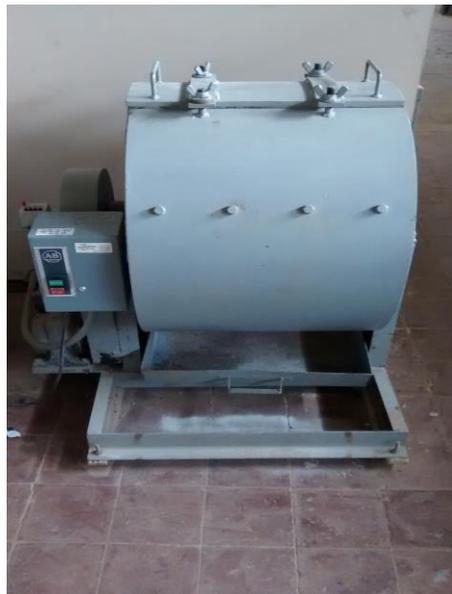
FIGURA 15: Instrumento utilizado en el desgaste de los ángeles.
