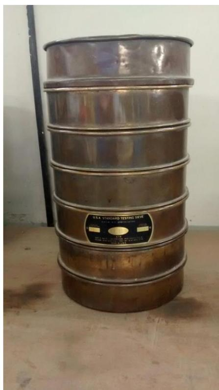
FIGURA 14: Tamices utilizados para análisis granulométría.
