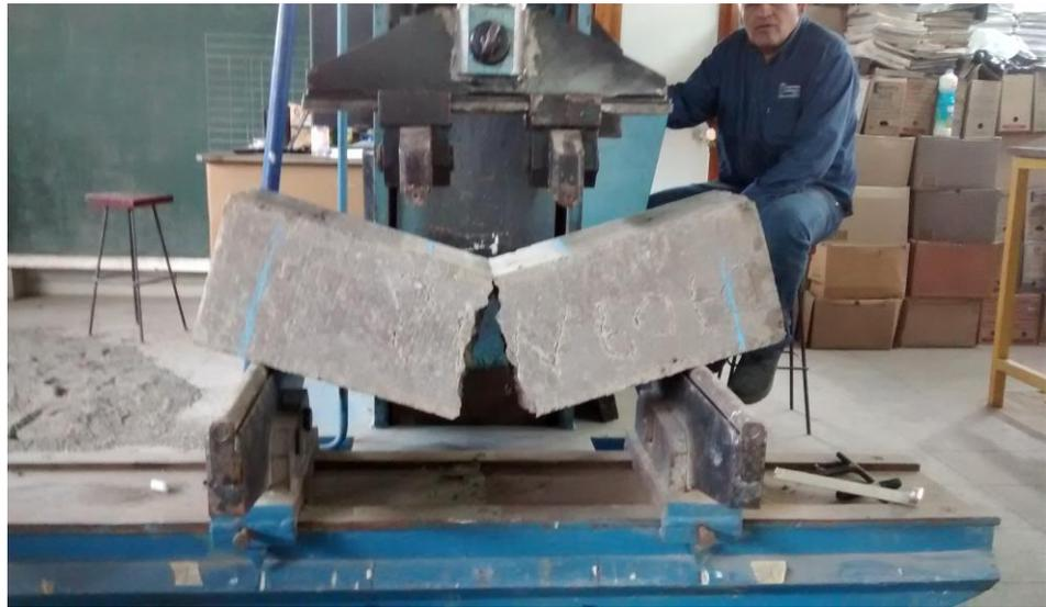
FIGURA 21: Momento de rotura del Ensayo a flexotracción
