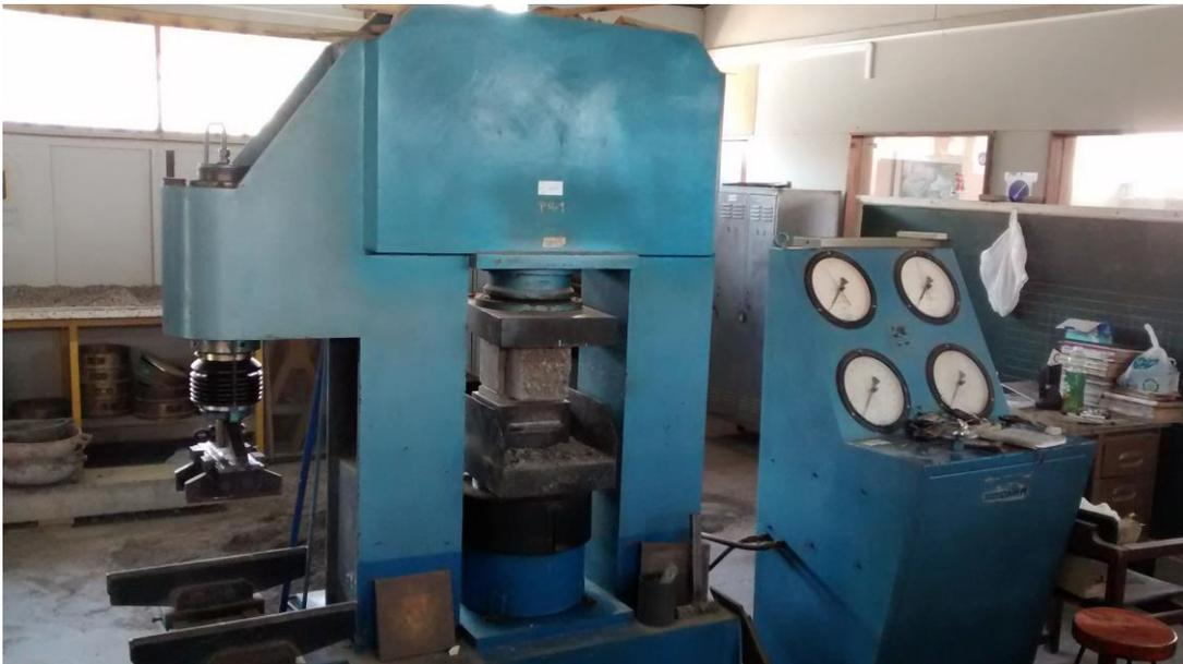
FIGURA 23: Prensa de ensayos
