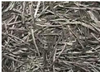
FIGURA 8: Fibra de Polipropileno (Forta-Ferro).
