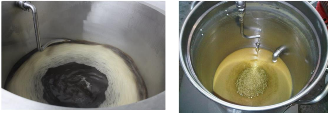
Figuras 3: Esquema del funcionamiento del separador Whirlpool
