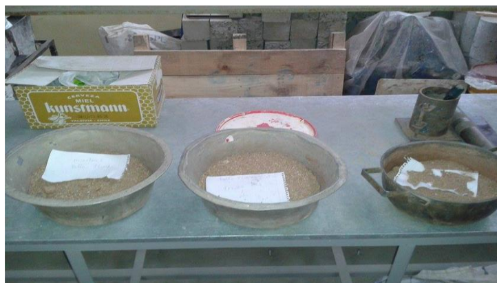
Figura 4.1: Muestra para realización de granulometría y límites de consistencia (Fuente: elaboración propia).
