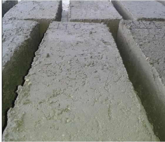
Figura 4.30: Ladrillo con 85% suelo, 6% cemento y 9 % de ceniza volante ( Fuente: elaboración propia)
