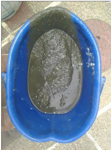
Figura 4.20.: Absorción indefinida e infinita de ladrillo con 85% suelo y 15% ceniza volante.
