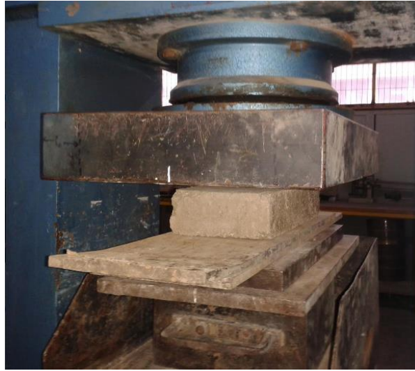
Figura 4.17.: Probeta ladrillo 85% suelo, 12% cemento y 3 % ceniza volante.
