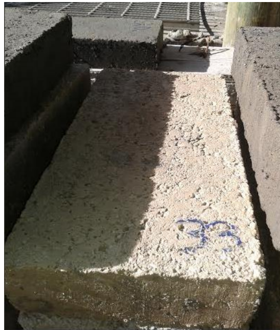
Figura 4.31: Ladrillo con 85% suelo y 15% de cemento ( Fuente: elaboración propia)
