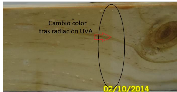
Figura 8.1 Cambio de color luego del envejecimiento acelerado Fuente: elaboración propia, 2014
