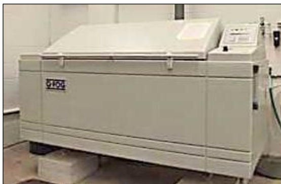
Figura 5.7 Cámara Q-FOG Fuente: Elaboración propia
