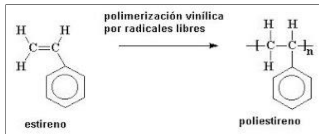
Figura 5.1. Polimerización a partir de estireno Fuente: Tecnología de los Plásticos, 2011
