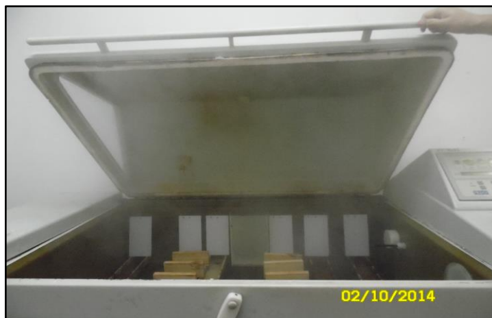
Figura 9.2 Probetas en cámara de niebla salina Fuente: Elaboración propia, 2014
