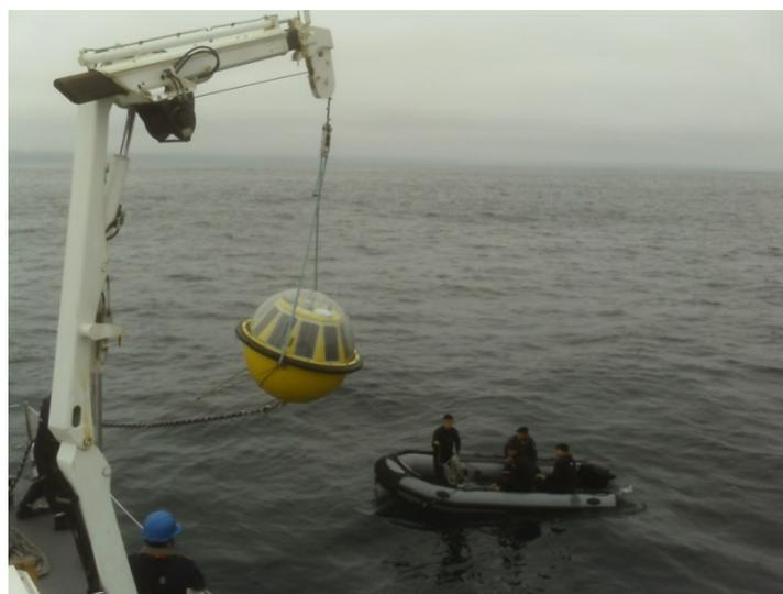
**Figura 4-5 Maniobra de instalación de la Boya Triaxys en Curaumilla. Fuente: Proyecto Undimotriz.**
