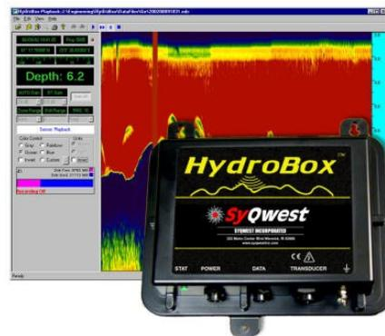
**Figura 4-3 Ecosonda Syqwest modelo Hydrobox de 200-33KHz.**
