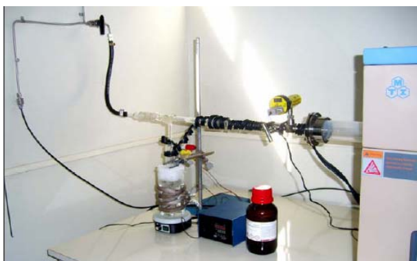
Figura 7. Imagen del arreglo experimental para introducir el TIPT en el reactor CVD.
