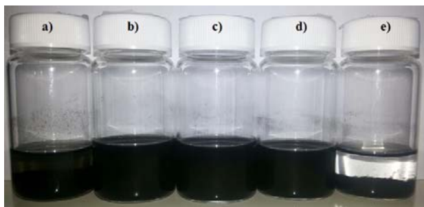
Figura 15. a) MWCNT puros, b) MWCNT-COOH M1, c) MWCNT-COOH M2, d) MWCNT-NO 2 y e) MWCNT-NH 2 en 2-propanol.
