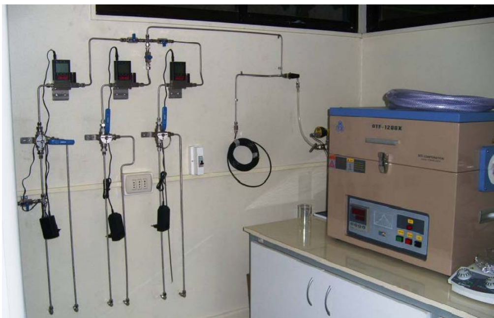
Figura 4. Sistema CVD para la síntesis de CNTs.
