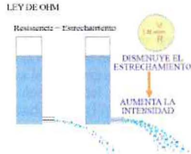
Figura 16. Representación gráfica del símil hidráulico de la ley de Ohm. Situación en la que la columna líquida se mantiene constante y varía la apertura de la válvula de salida. A menor apertura mayor resistencia y menor intensidad de corriente. A mayor apertura, menor resistencia y mayor intensidad de corriente.
