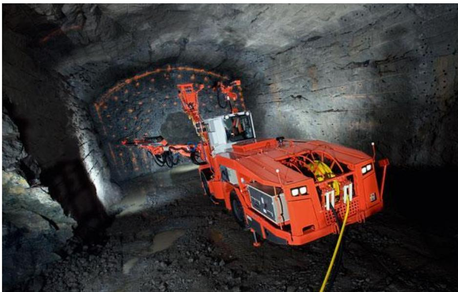
Después de la tronadura, se extrae el material fragmentado y se estabilizan las paredes y el techo del túnel. Para esto, se utiliza una fortificación adecuada para cada tipo de terreno, que depende de sus características y del uso que se le va a dar al túnel, pique o rampa. Entre cada tronadura, el sector debe de ser ventilado y despejado.
