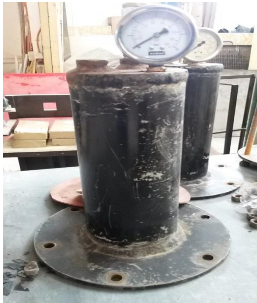
Figura 4.4: Probetas para ensayo de permeabilidad.
