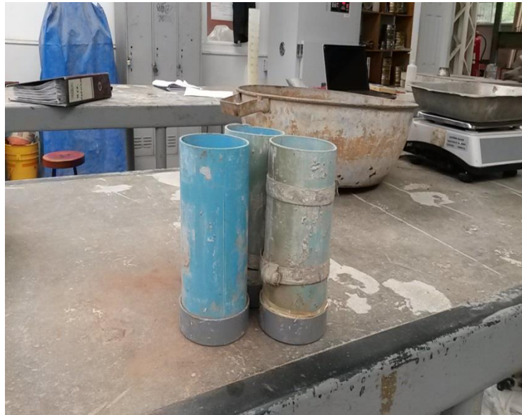
Figura 4.3: Probetas para absorción capilar.
