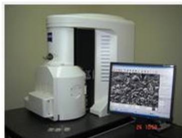
Figura 13. Representación del sistema de SEM acoplado a EDS.
