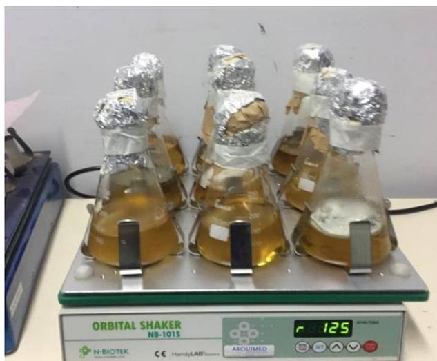
**Ilustración 3.8: Matracas colocados en shaker orbital.**
