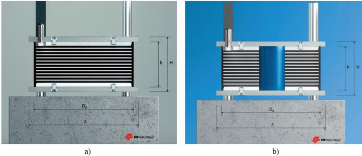
Figura 5.1. a) Aislador elastomérico. b) Aislador elastomérico con núcleo de plomo. Donde H es la altura total incluyendo las placas de acero, h la altura total de elastómero, Dg el diámetro del elastómero y Z la longitud total de las placas de acero.
