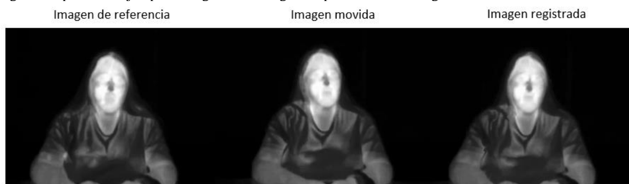
Figura 4: La siguiente secuencia de imagen muestra el resultado de registro de imagen, al alinear una imagen movida con respecto a una imagen de referencia que se encuentra centrada.
