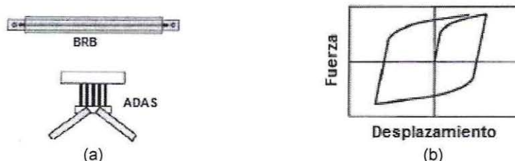
Figura 2.2 (a) Disipador metálico; (b) Comportamiento histerético idealizado [4]
